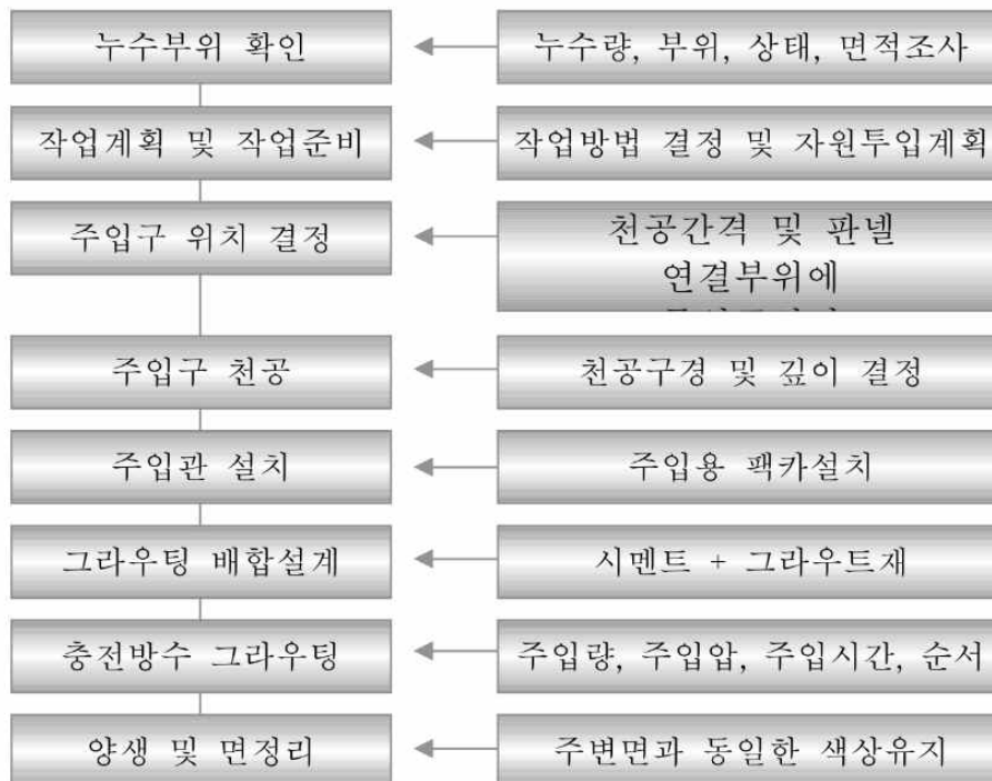
【그림 6.3.10】 충전주입방수 공법의 시공순서도
